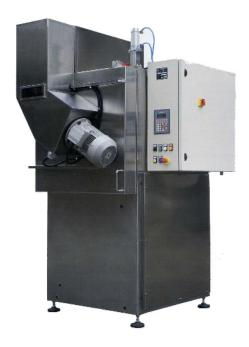
Grenailleuse a azote liquide pour la rectification de produits techniques en caoutchouc, silicone, plastique, etc.
