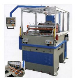
Machine pour le decoupage de manchons en caoutchouc:
