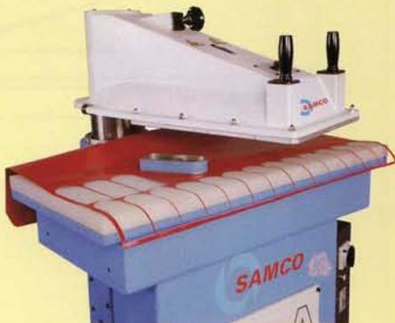
L'opérateur déplace le bras manuellement au-dessus de la lame de l'emporte-pièce et commande l'opération de découpe en pressant simultanément les deux boutons placés sur le haut des poignées. Une fois la course de découpe terminée, le bras remonte automatiquement. L'opérateur déplace le bras sur le côté, dégageant ainsi la table pour la collecte des pièces et le repositionnement de l'outil.
